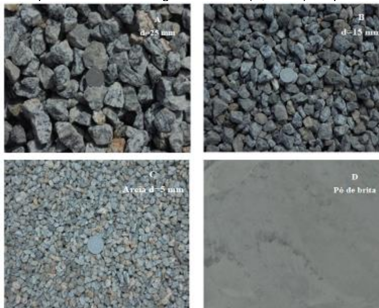
Figura 3 - O produto de diferente granulometria (A, B e C) e o pó de brita (D).
