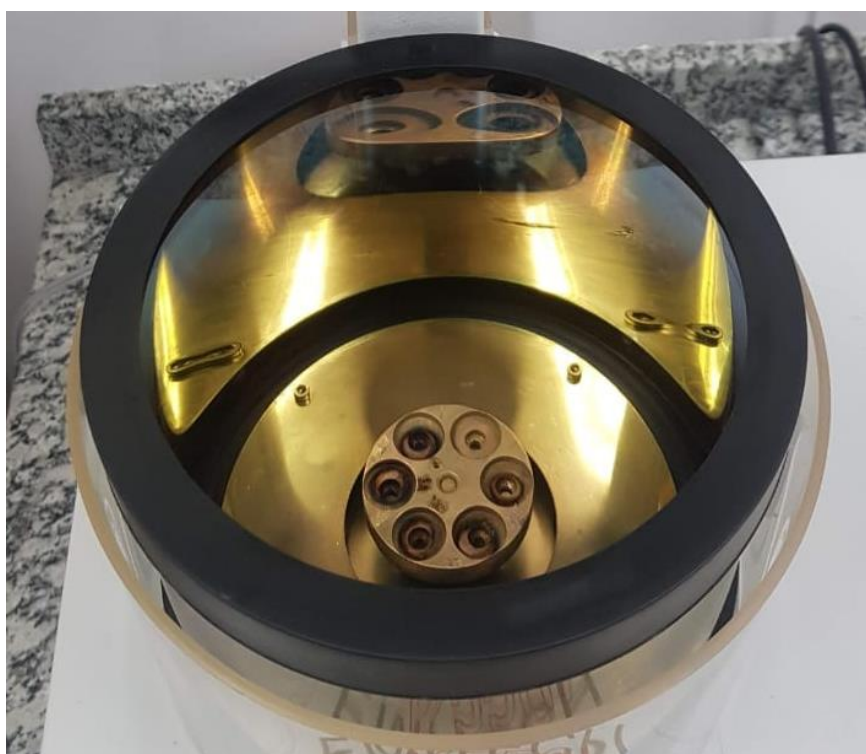
Figura 5 - Vista interna do metalizador com suporte dos "Stubs" em que foram fixadas as amostras.
