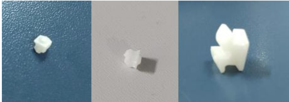
Figura 1 - Bráquetes cerâmicos de zircônia confeccionados pelo sistema CAD/CAM em resolução 1x, 2x e 3x da escala real, respectivamente.
