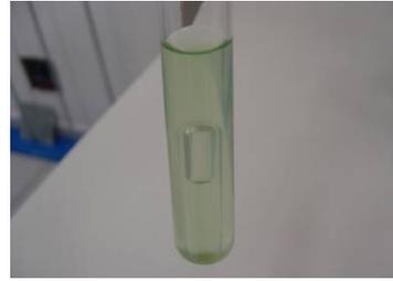
**Fig. 1 - Tubo de Durhan invertido com turvação, caracterizados pela ausência da coloração esverdeada do caldo.**
